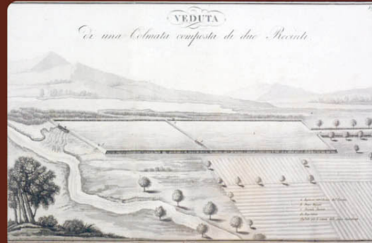
Archivio di Stato Firenze, Esempio di colmata a due recinti adottata in Chiana da A. Manetti agli inizi del XIX secolo.
